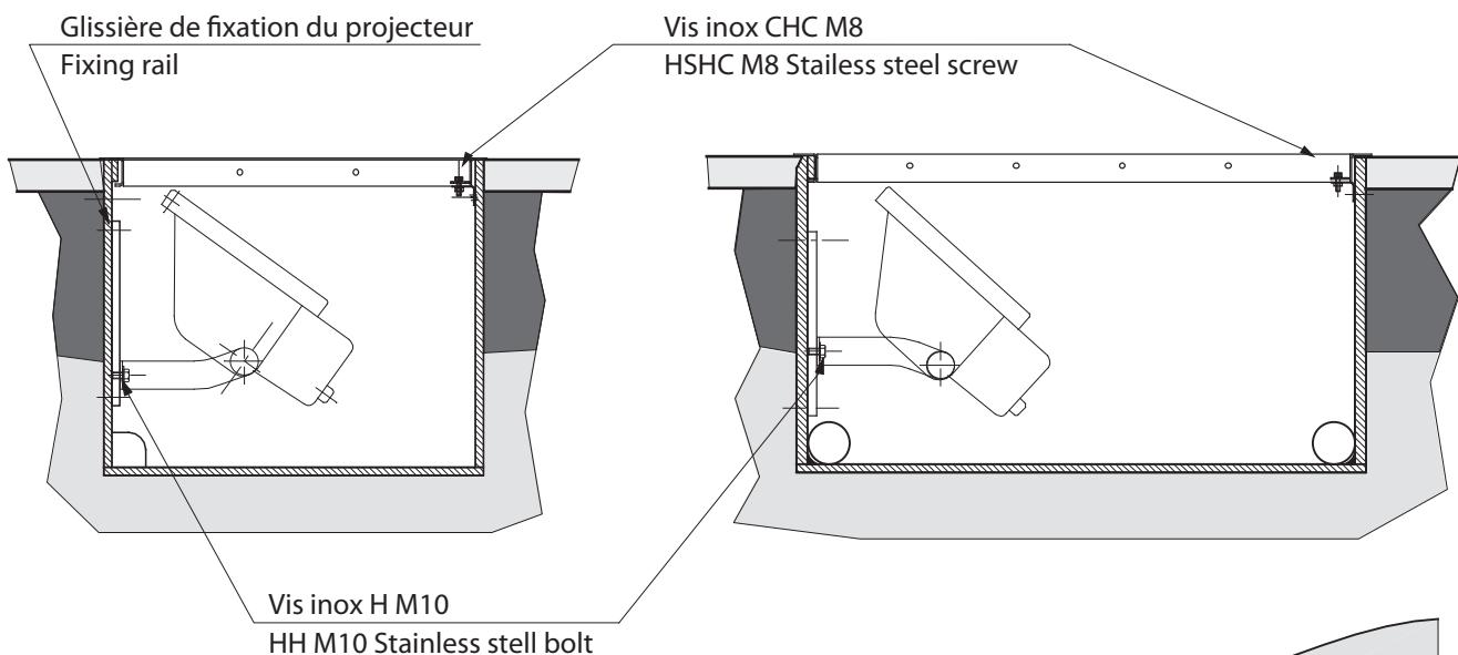
Scellement béton adapté aux pressions de surface
