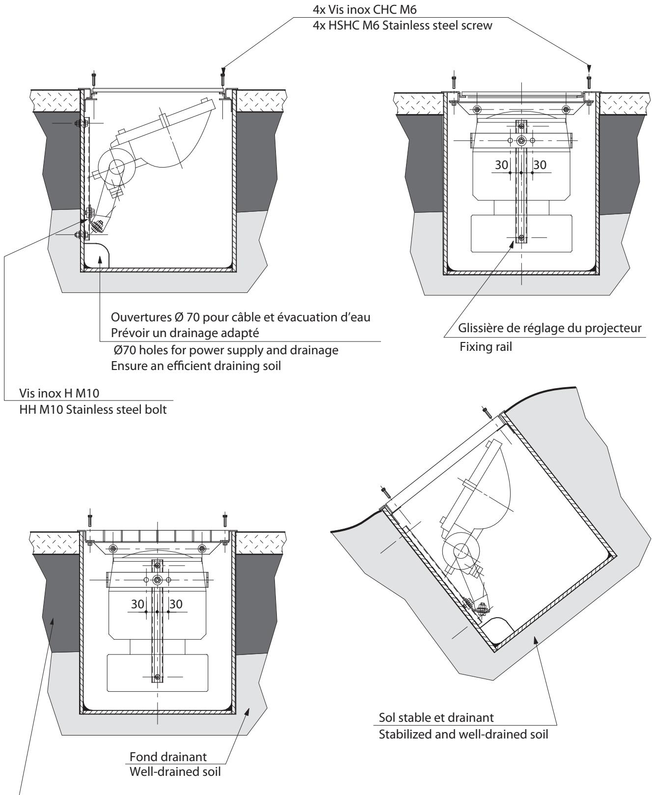
Scellement béton adapté aux pressions de surface
