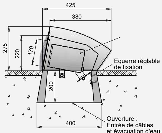
Prévoir un système de drainage efficace raccordé sur un réseau si nécessaire.
